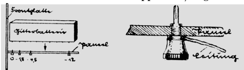
Abb. 1 und 2. Die Gitterbatterie wird verkehrt auf die Stöpsel gestülpt, die von unten durch die Montageplatte durchgehen u. gleichzeitig so die Batterie halten.
